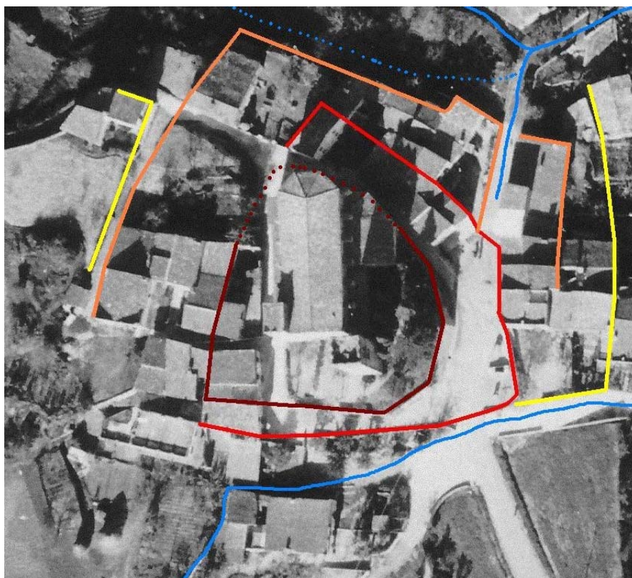
Fotografia aèria de la Força, on es marca la situació hipotètica de les muralles de diferents recintes, segons Higiní Herrero, membre del Centre d'Estudis de Sant Pere de Vilamajor, que va determinar-les pel gruix d'algunes parets de cases, de 90 cm.
