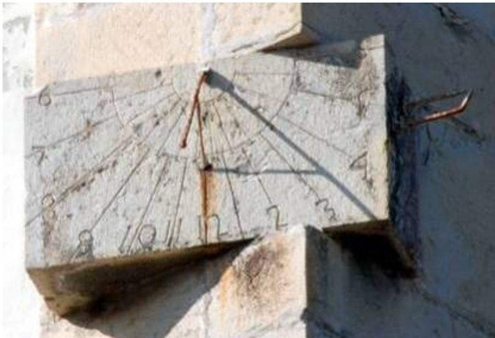
Reloj de sol doble: cuadrante vertical a mediodía. Varillas.
