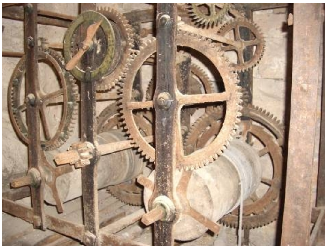
Quintanilla de la Ribera. Maquinaria del reloj mecánico de la torre.
