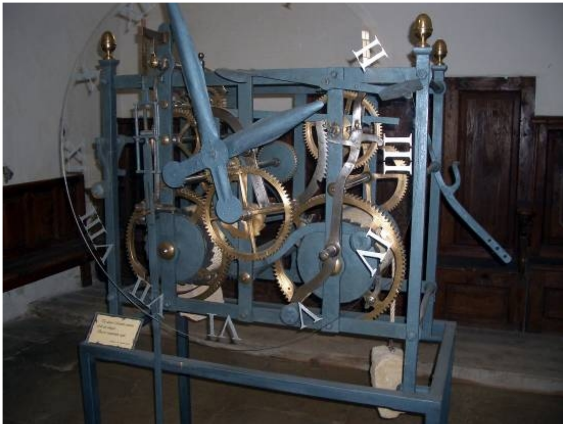
Maquinaria del reloj mecánico de Bachicabo.
