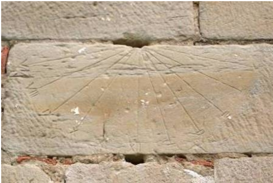
Reloj 2. Semicircular de 12x15°. Varilla polar acodada.
