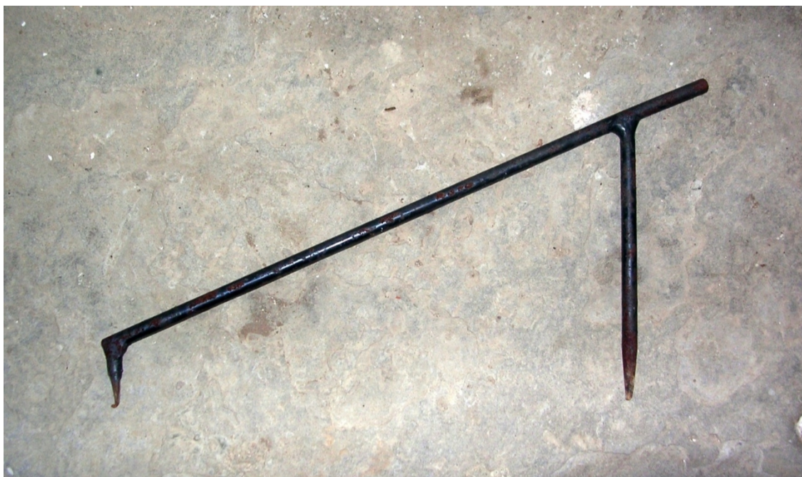
El varilla forma un ángulo de 68^\circ con el tramo de apoyo.
