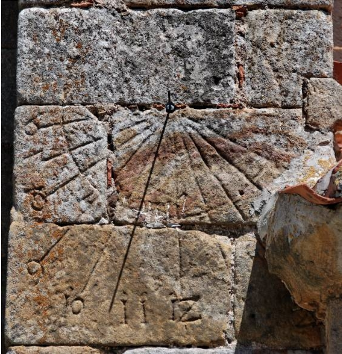
Reloj 2. Circular en junta de sillar. Vertical declinante a levante..
