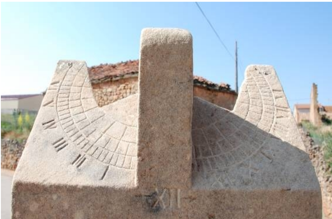
Reloj 7. Ecuatorial. Plano paralelo al plano ecuatorial. Horas en números romanos de VI de la mañana a VI de la tarde. Líneas de horas, medias horas y cuartos de hora. Arista central izquierda: marca de VI a XII. Arista central derecha: marca de XII a VI. Funciona desde el equinoccio de primavera al equinoccio de otoño. Es mediodía cuando ninguna de las dos aristas proyecta su sombra sobre el reloj.
