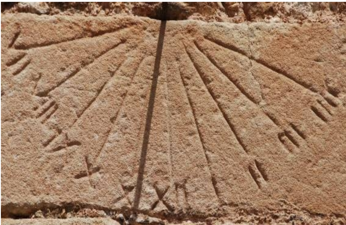
Radial en junta de sillar. Horas en números romanos, de VII de la mañana a IV de la tarde. IIII de notación aditiva. Línea de mediodía desviada hacia la derecha: el muro declina a levante. Varilla horizontal de hierro.
