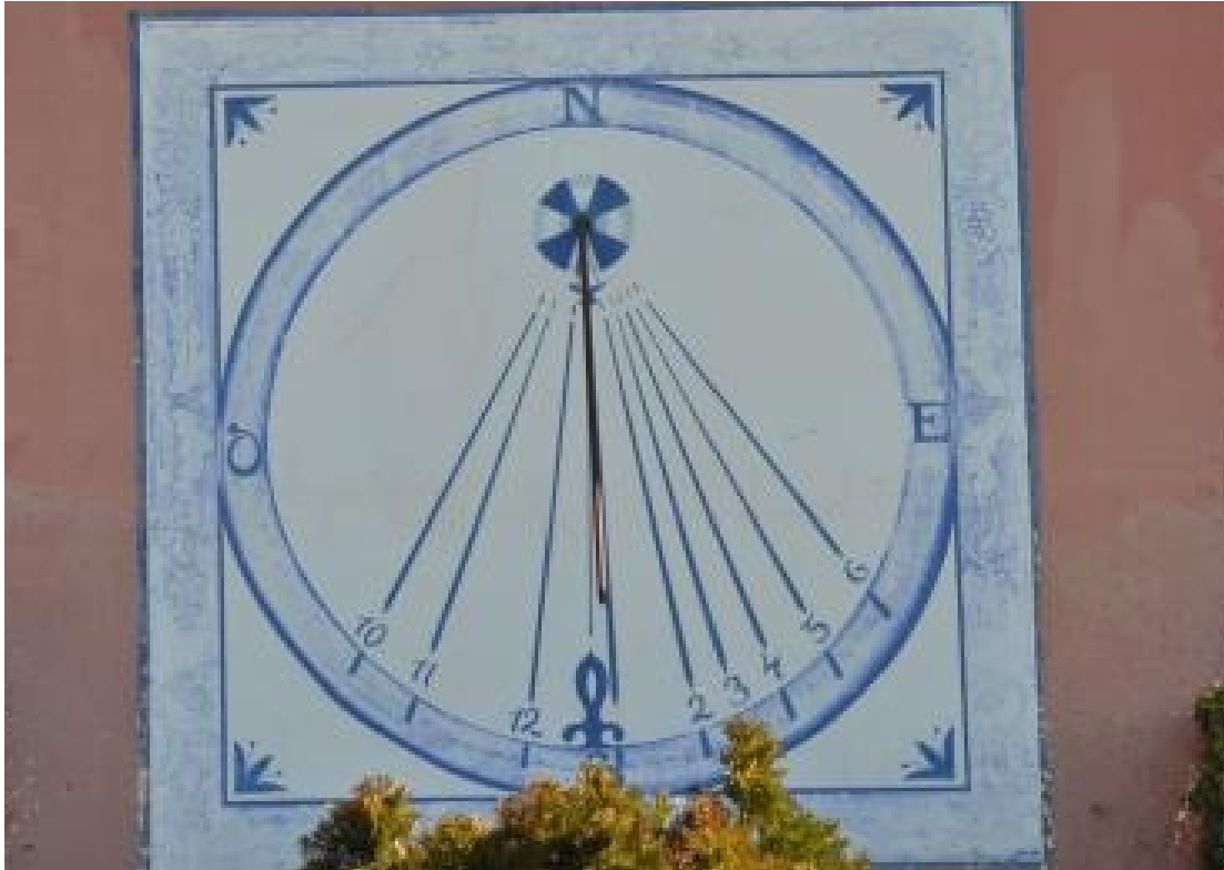
Circular inscrito en un cuadrado. VDP. Línea de las doce girada hacia la izquierda. Horas en números arábigos, de 10 de la mañana a 6 de la tarde. Puntos cardinales. Varilla de un apoyo.
