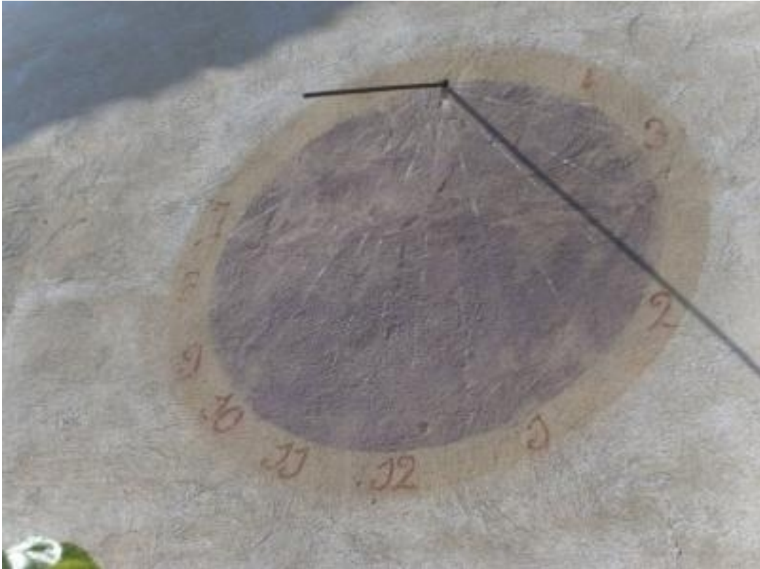
Vertical declinante a levante. De siete a cuatro. Cifra 1 en anzuelo.
