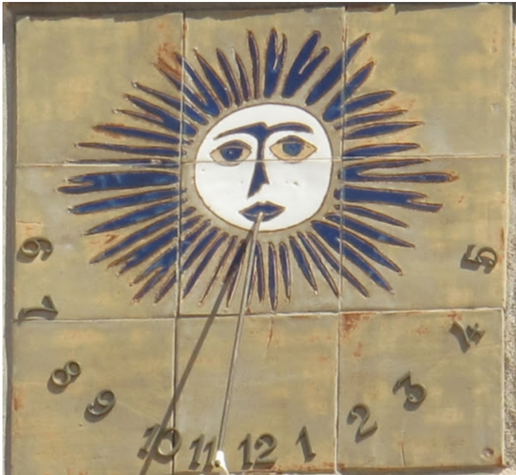
Mural cerámico de 3x3. Sol decorando el polo. VDL. Sin líneas. Números metálicos, de 6 de la mañana a 5 de la tarde. Varilla de un apoyo.
