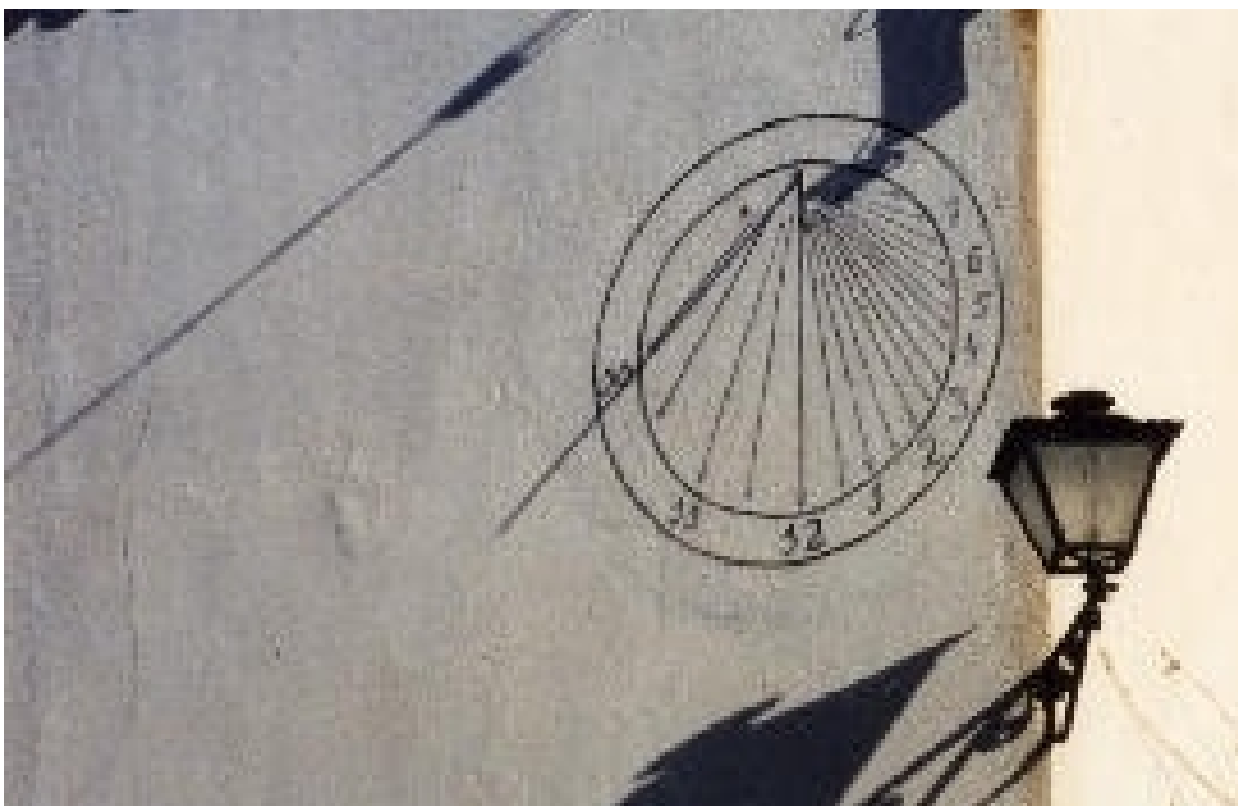
Circular. VDP. Horas en números árabigos, de 10 de la mañana a 8 de la tarde. Cifra 1 en anzuelo. Líneas de medias horas de la misma longitud que las horarias.
