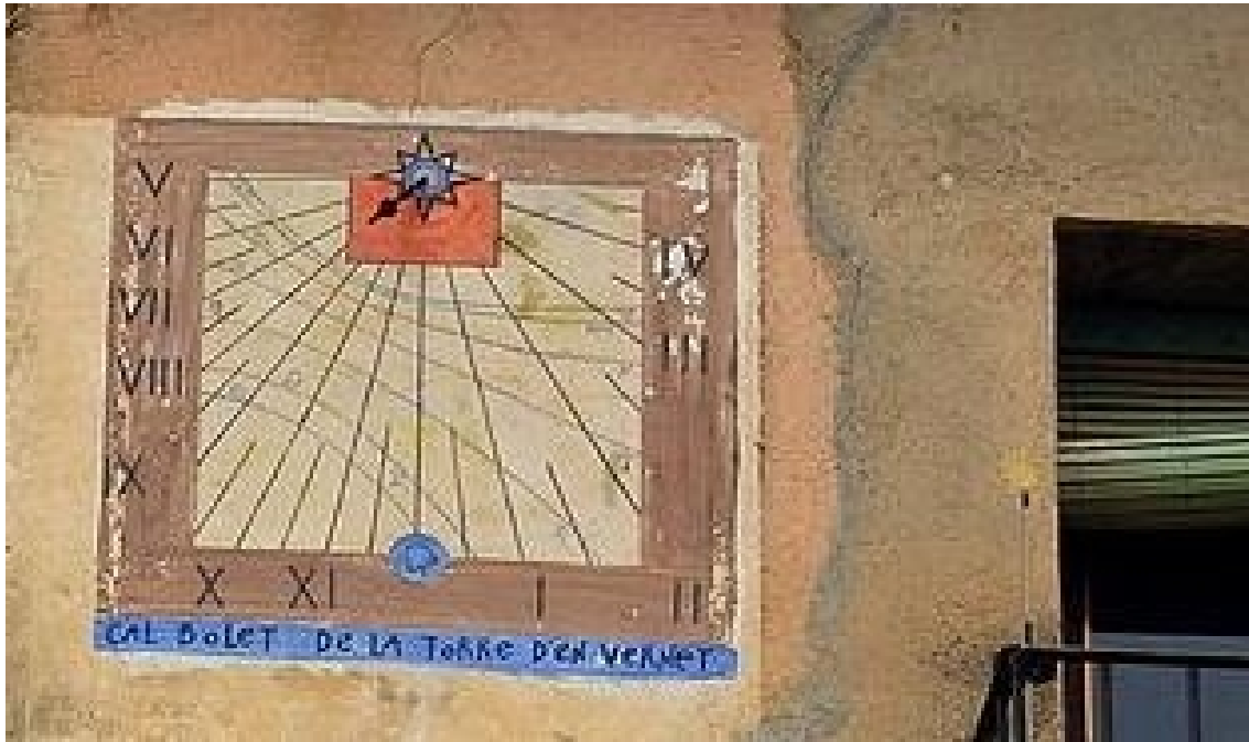
Rectangular horizontal. Rectángulo distribuidor. Estrella de ocho puntas en el polo. Horas en números romanos, de V de la mañana a IV de la tarde. ´ Campanita del Ángelus. Medias horas. Líneas de fecha. Signos del zodiaco. Varilla de un apoyo con una marcador (bolita) en su centro. Inscripción: CAL BOLET DE LA TORRE D'EN VERNET.
