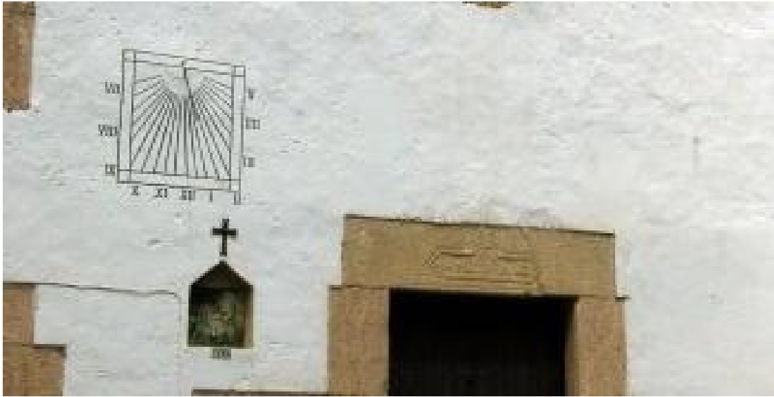
Cuadrado. VDP. Numeración en romanos, de VII de la mañana a V de la tarde, pintada por el exterior del marco. Varilla de un apoyo.
