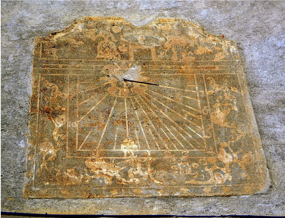
Rectangular rematado en frontón mixtilíneo. Cierta parecido en los motivos decorativos con el reloj de sol de Can Rigola d'Amunt. Sol en el polo. VDP. Horas en números arábigos, de 9 a 7 de la tarde. Varilla de un apoyo.
