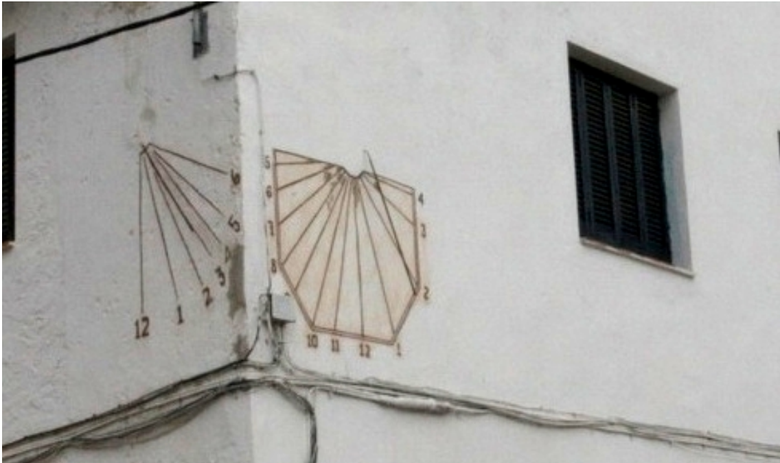
Reloj de sol doble: VDL y VDP.
