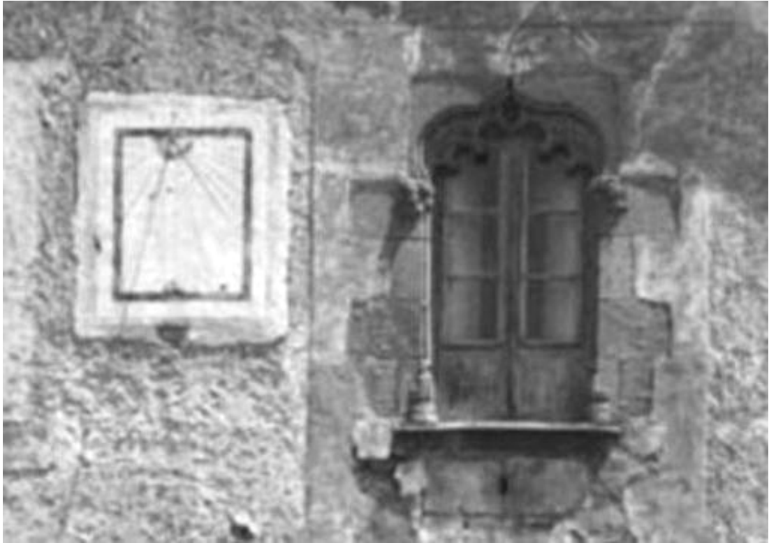
Rectangular. Polo desplazado hacia la izquierda. Semicírculo distribuidor. Vertical declinante a poniente. Campanita del Ángelus. Varilla de un apoyo.
