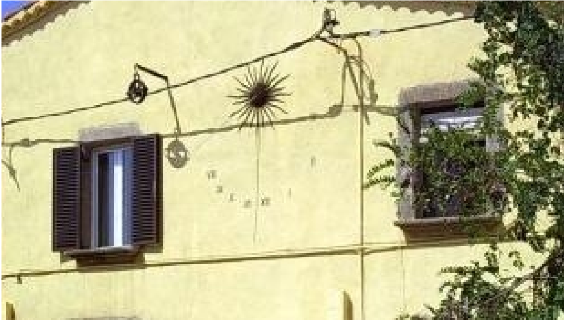
Radial. Sol decorando el polo. Números arábigos. Varilla de un apoyo.
