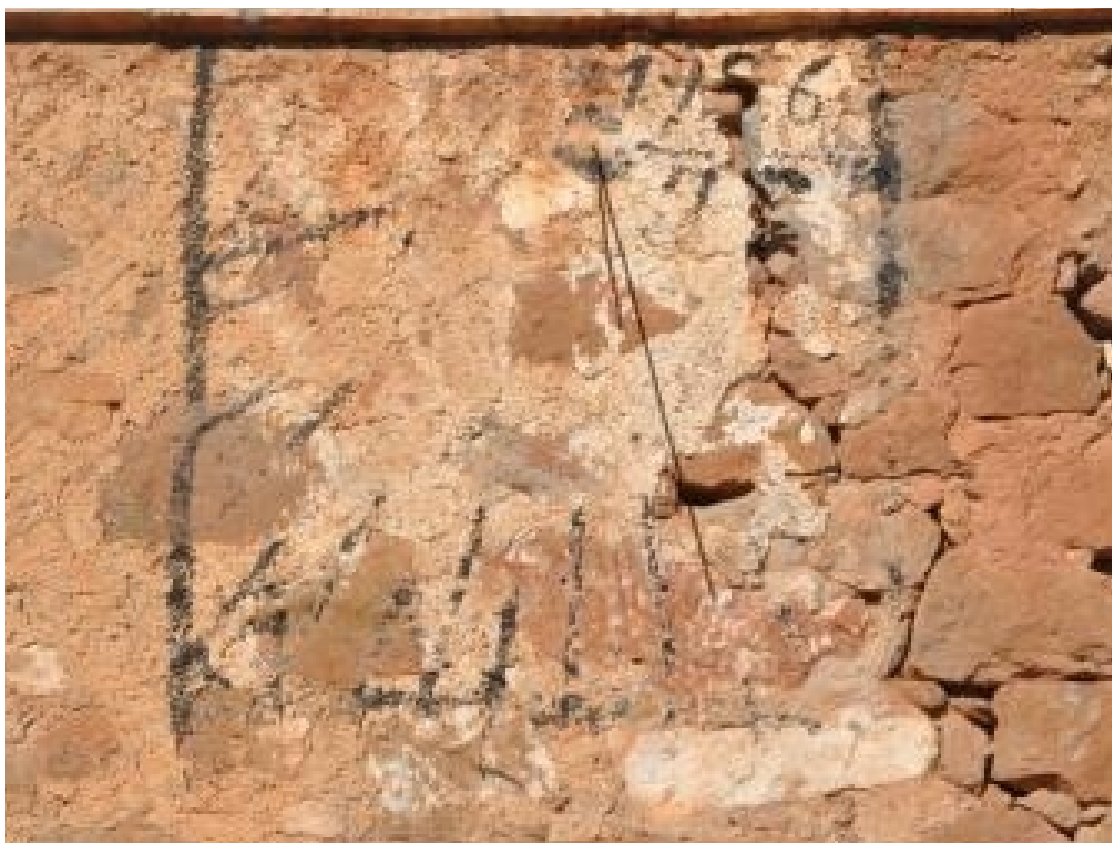
Cuadrado pintado de negro. Marco simple. Polo desplazado hacia la derecha. VDP. La línea de mediodía no es vertical. Varilla de un apoyo mal orientada. Fecha en la parte superior: 1986.
