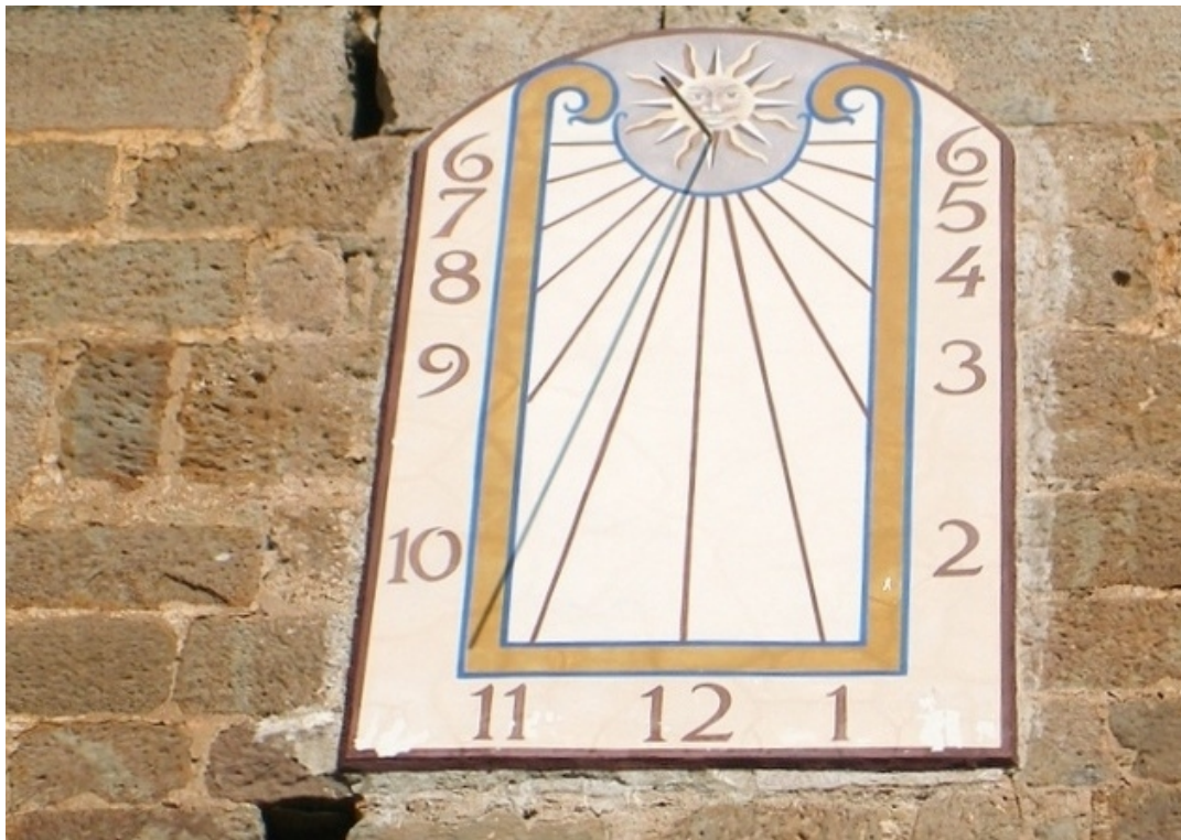
Rectangular rematado en arco rebajado. Cara de sol sobre el polo. VM. Horas en números arábigos, de 6 de la mañana a 6 de la tarde. Varilla de un apoyo.
