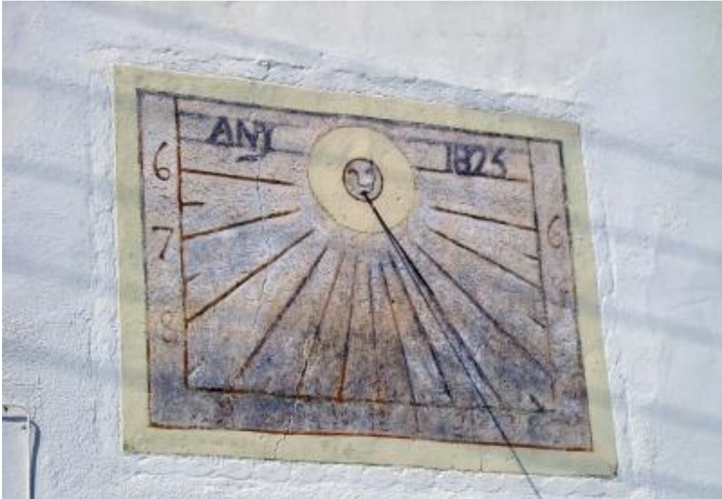
Esgrafiado y pintado sobre una superficie enlucida. Rectangular horizontal. Círculo distribuidor con una pequeña cara circular concntrica. VM. Horas en arábigos, de 6 de la mañana a 6 de la tarde. Líneas de medias horas. Varilla de un apoyo. Inscripción de fecha: ANY 1825.
