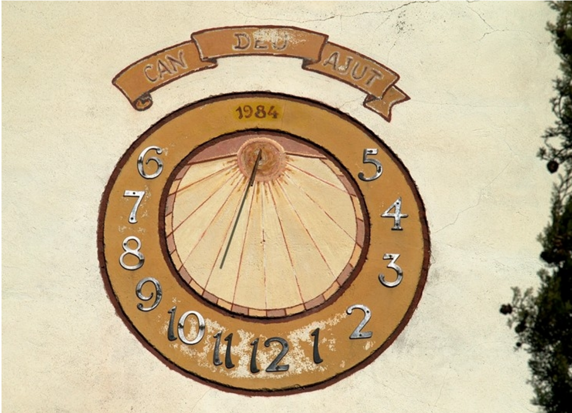
Circular. El círculo interior no es concéntrico. Sol en el polo. VDL. Horas en números arábigos de chapa de hierro, de 6 de la mañana a 5 de la tarde. Medias horas. Fecha: 1984. Inscripción en un filacteria encima del reloj: CAN DEU AJUT.
