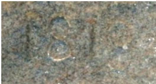
Las superficies semicilíndricas izquierda y superior están numeradas en romanos. La izquierda, de I a V siguiendo el borde del semicírculo, y el VI mal situado en la esquina inferior izquierda. La central, mal numerada de I a V, cuando debiera marcar VII a XI. En la superficie semicilíndrica derecha se ha utilizado numeración combinada: VII, VIII, IX, 10, 11 y XII, este último número grabado en la esquina inferior derecha. Líneas de medias horas. Fecha inscrita en el centro de la cara sur.
