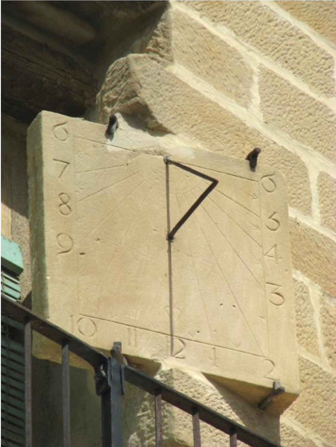
Vertical a mediodía orientado. Las doce. Hora solar.
