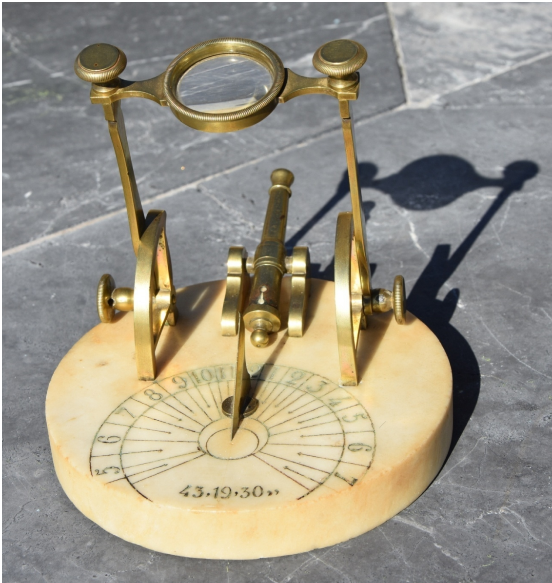
Cañón de mediodía calculado para la latitud de Donostia-San Sebastian.
