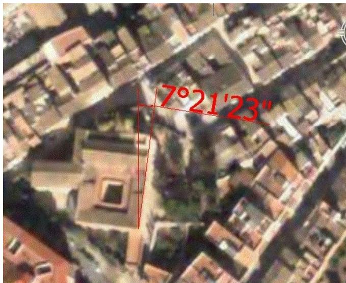
El ángulo de declinación de la pared y como consecuencia de colocación de las losetas con respecto a la Meridiana da un valor de  $8^{\circ} 30' 15''$  que se corresponde con un valor, con un error cercano a un grado, observado con la línea Norte-Sur de una imagen aérea del convento captada del Google Earth.
