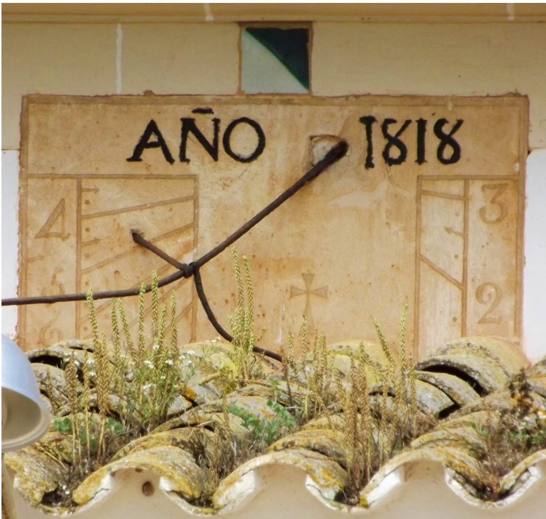
Rectangular horizontal. Vertical declinante a levante.
