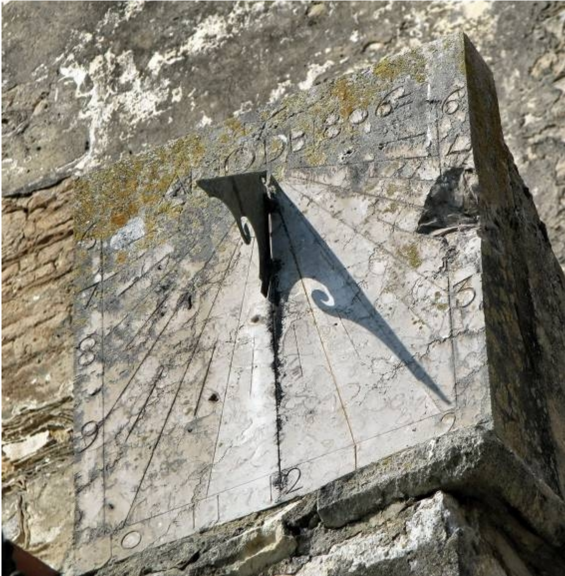
Vertical a mediodía orientado.
