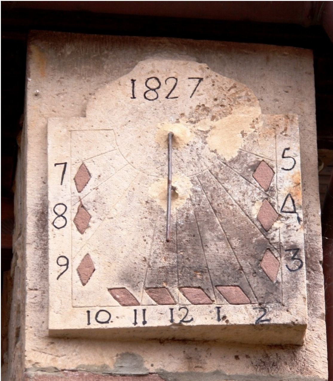
Vertical a mediodía orientado.
