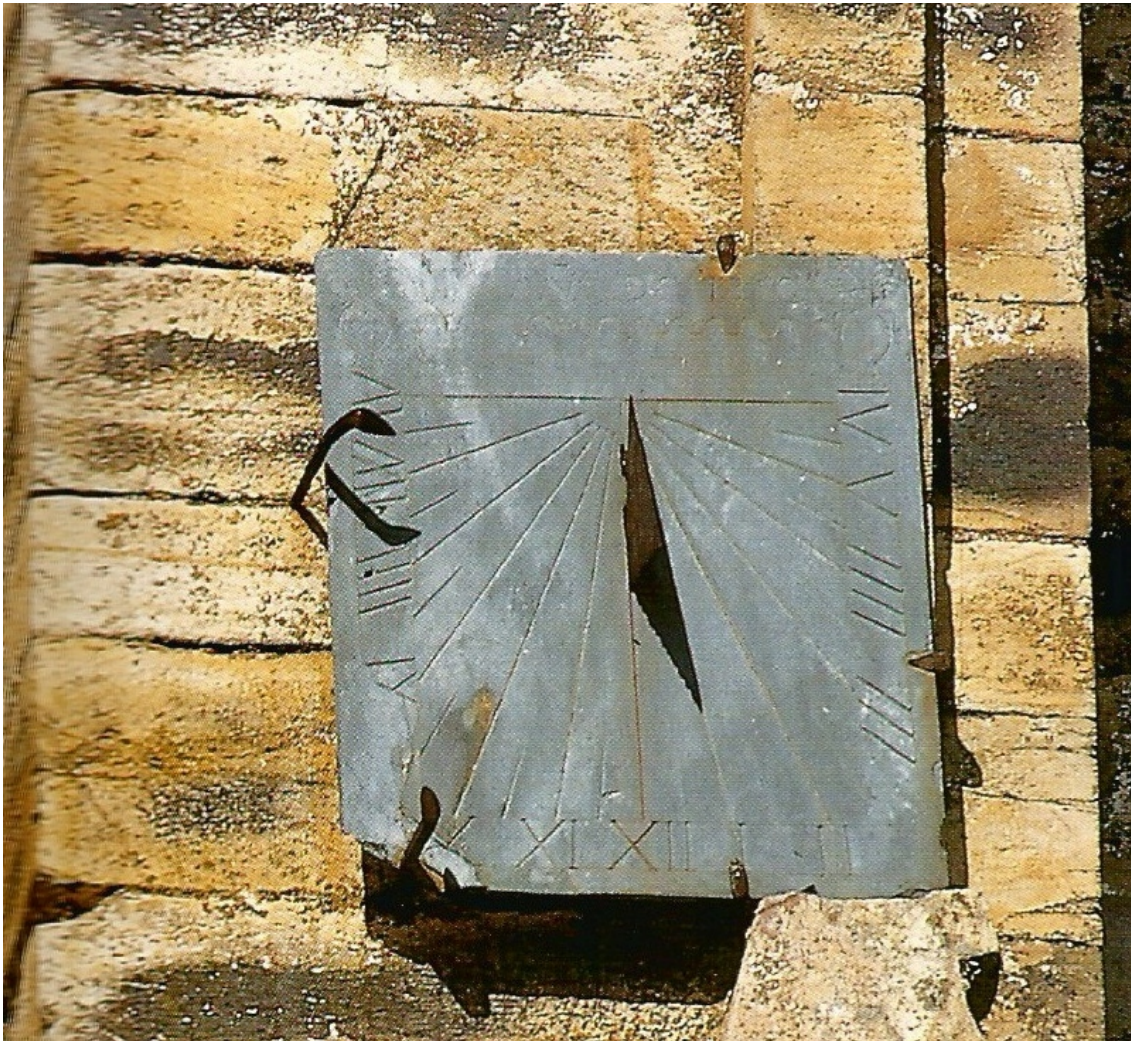
Cuadrado. Vertical a mediodía orientado. RSeL.
