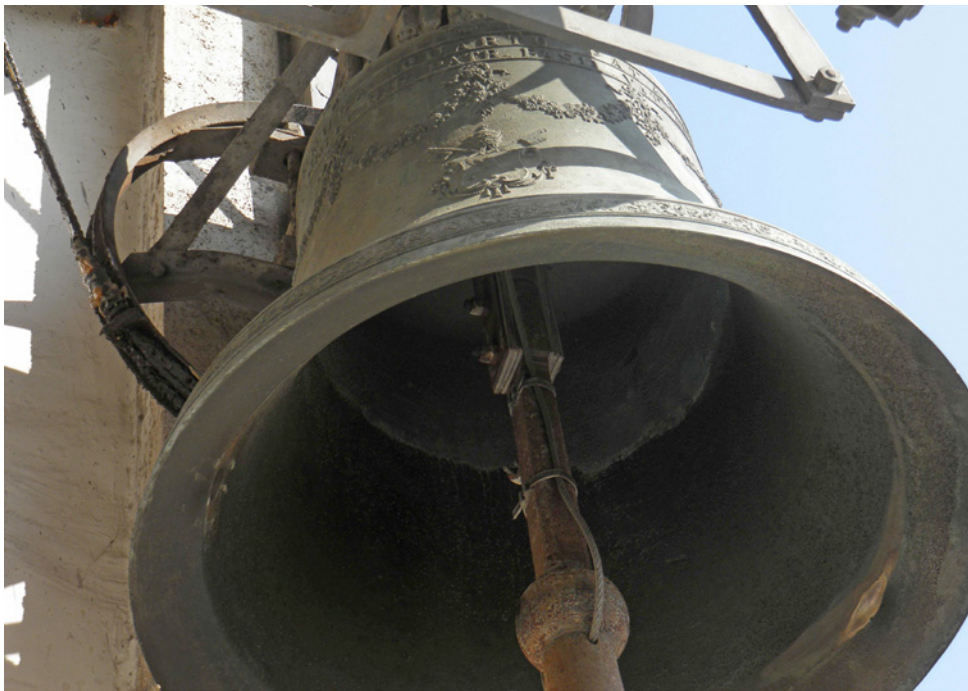
El Ave María vista de cerca. Se aprecia la decoración del ejemplar y el lugar donde golpea el badajo cuando se voltea. Obsérvese también la seguridad del badajo fuertemente sujeto con tornillos y un cable metálico. Esto impide que por algún fallo mecánico el badajo salga despedido en los toques
