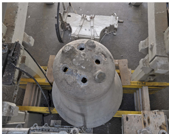
Campana de la Rota bajada para ponerla a tono. Obsérvense los orificios practicados en la parte superior para colgarla, una vez que, desde tiempo impreciso, se habían quebrado las asas
