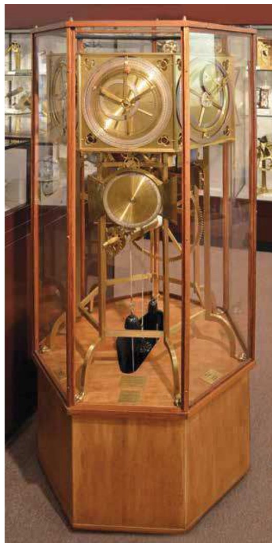
Cambridge, Whipple Museum. Reconstrucción del Astrario de Giovanni Dondi. Indicaba la posición de los cinco planetas, el sol y la luna en siete esferas diferentes. Todas ellas eran movidas por una gran rueda de 365 dientes que daba una vuelta al año y que servía de calendario. La máquina tenía engranajes elípticos para las órbitas de la Luna y Mercurio, y movimientos de gran complejidad para simular los epiciclos. El Astrario probablemente desapareció en las Guerras de Italia, pero su excepcionalidad lo hizo legendario y su memoria perduró, del mismo modo que el la del reloj astronómico de Richard de Wallingford.
