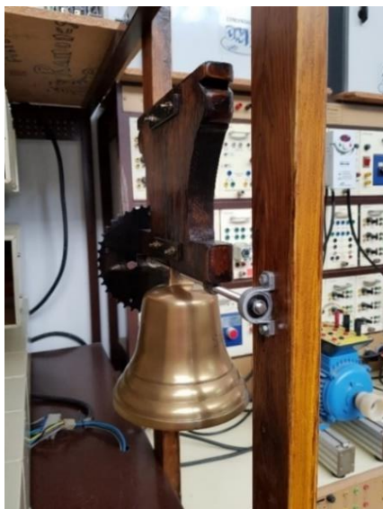
Figura 13. Vista del perfil esquerre de la campana i del sistema d’ancoratge.
