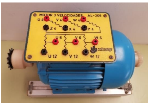
Figures 15, 16 i 17. Motor de 3 velocitats amb pinyó motriu acoblat al seu eix amb caragol de M6 i sobre peça de niló que emula la xaveta, variador de freqüència SD 100 i mòdul lògic programable LOGO V8.
