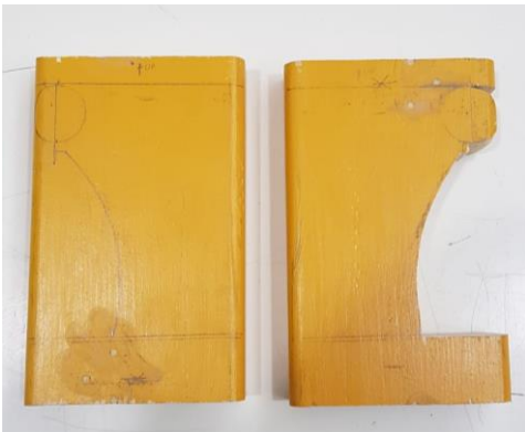
Figures 2 i 3. Dues parts simètriques de la truja. Fase de serrat i llimat de la fusta en el caragol de banc de mecanitzat. La fusta és de pi treta d'un tauló pintat de color groc de 185x12,5x3 cm, i que en origen feia la funció de penjador.
