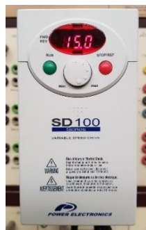
Figures 15, 16 i 17. Motor de 3 velocitats amb pinyó motriu acoblat al seu eix amb caragol de M6 i sobre peça de niló que emula la xaveta, variador de freqüència SD 100 i mòdul lògic programable LOGO V8.
