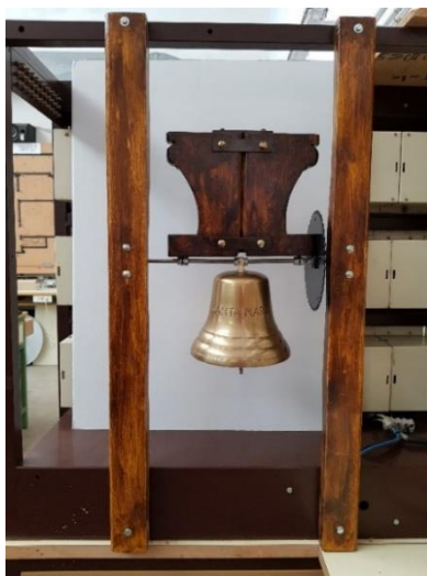
Figura 14. Vista en alçat del conjunt de la campana ja equilibrat.
