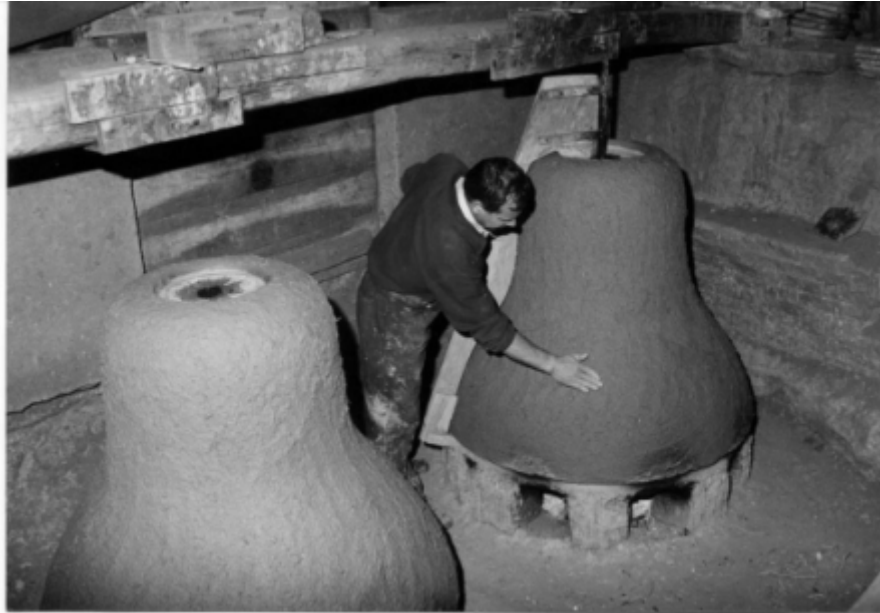
Lám. 29. Ultimando la cubierta exterior de arcilla.
