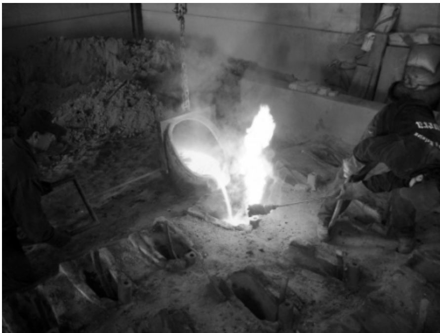
Lám 30. Vaciado del bronce en los moldes enterrados.
