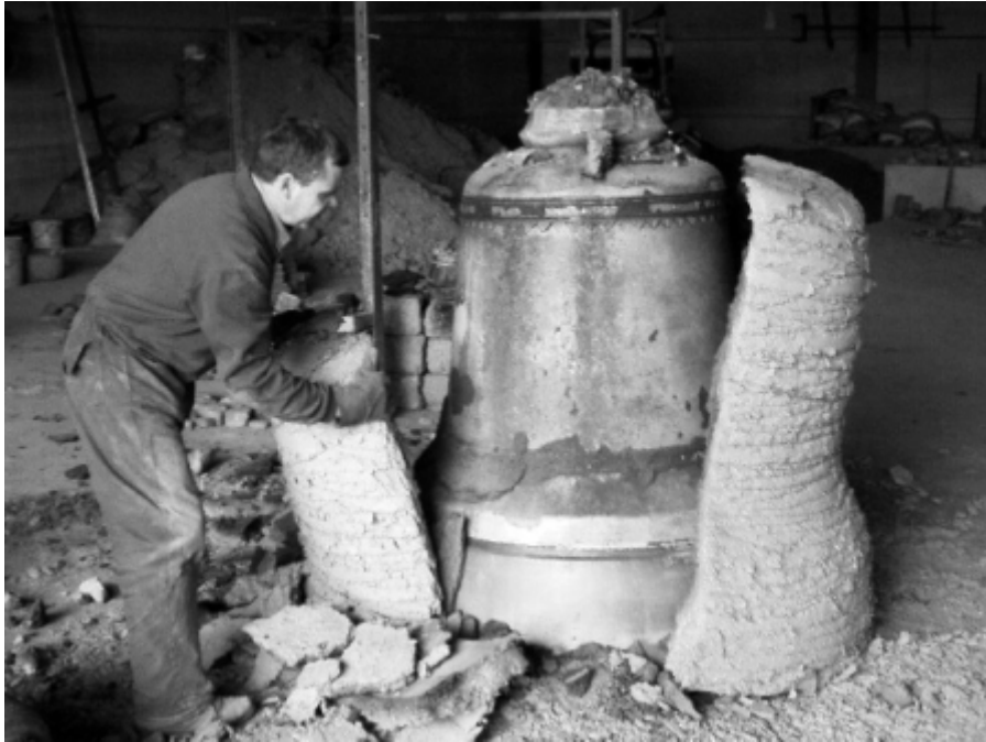
Lám. 31. Extracción del molde exterior ("tercero").
