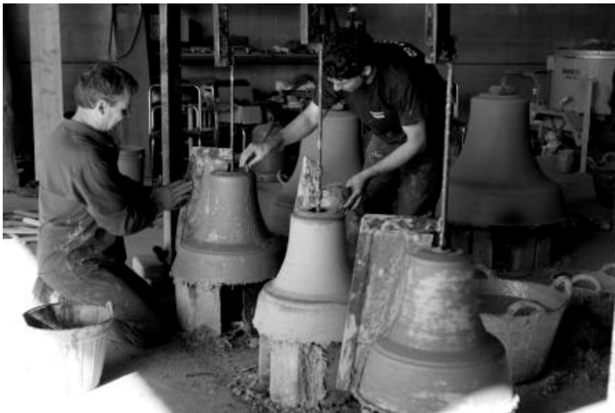
Lám. 26. Preparando los moldes internos.
