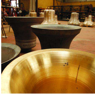
RESULTADO FINAL. TRAS UN CHORRO DE ARENA A ALTA PRESIÓN Y EL TORNEADO, LA CAMPANA ESTÁ TERMINADA.
