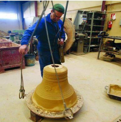
LISTA PARA LA FUNDICIÓN. EL MOLDE ESTÁ TERMINADO, CON LAS INSCRIPCIONES Y GRABADOS A LA CERA PERDIDA.
