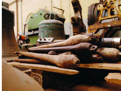
BATAJOS, EL COMPLEMENTO NECESARIO, FABRICADO GENERALMENTE CON HIERRO DULCE. EL BATAJO GOLPEA SIEMPRE EN EL MISMO PUNTO DEL ARCO DE SONIDO DE LA CAMPANA.
